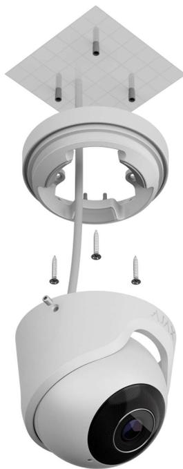
5. Установіть корпус камери в тримач так, щоб об'єктив камери був спрямований на зону під охороною. Закрутіть два гвинти в тримачі за допомогою комплектного шестигранника ( $\varnothing$  2 мм).
