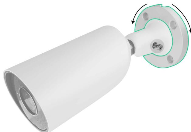
4. Протягніть кabelь через канал для кабелю та закріпіть поворотний монтажний кронштейн комплектними шурупами на поверхні.
